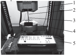
1—上夹头;2—LGFRPP 试样;3—应变片; 4—下夹头;5—电阻应变仪
